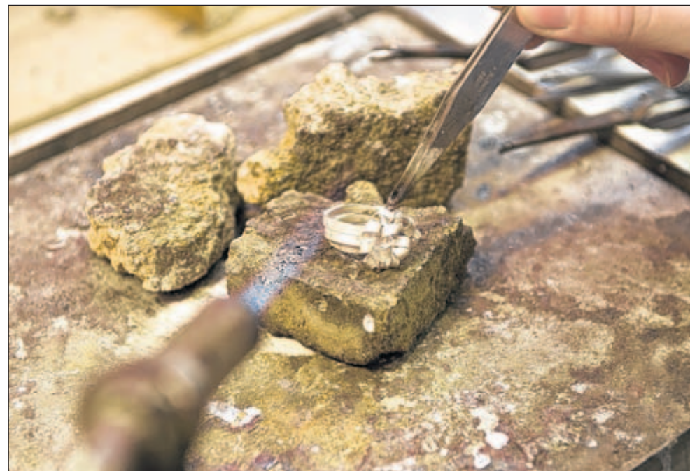
Om tot het uiteindelijke sieraad te komen, voer je verschillende metaalbewerkingen uit zoals solderen, vijlen, buigen, slijpen en polijsten.
